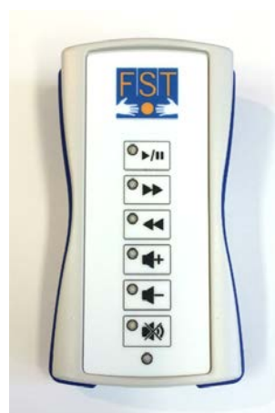
Face avant du MusicSwitch, avec clavier membrane.
